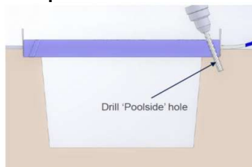
Fig. 4 - Perforación utilizando la plantilla de perforación
