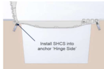
Fig. 9 – Inserción de los tornillos de cabeza de socket (SHCS) de DalFLEX en el lado de la bisagra.
